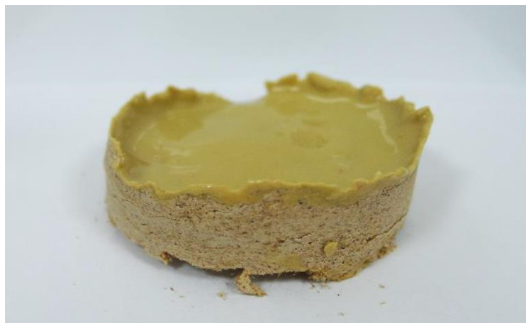
Рисунок 3. Сформированная пробка состава ULTRA BLOCK.
