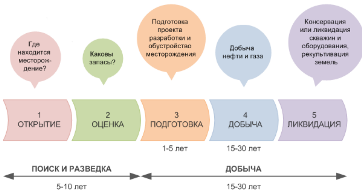
Рис. 1. Схема процесса добычи нефти и газа
