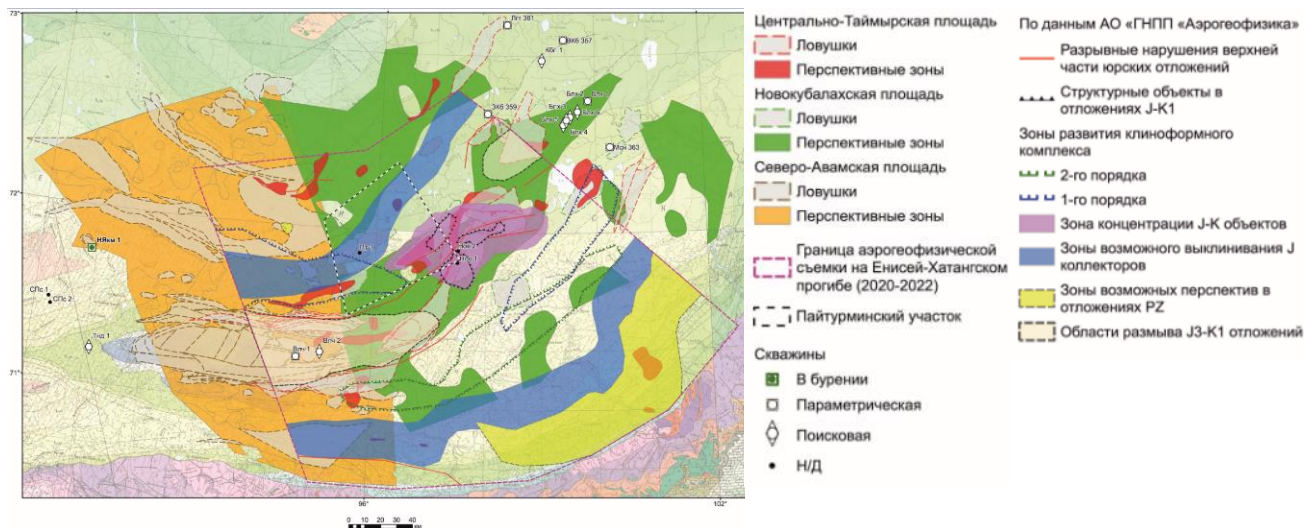
Рисунок 5. Сводная схема прогноза УВ и направлений геологоразведочных работ с учетом выделенных перспективных зон и объекты по сейсмическим съемкам 2014-2022 годов. Особенностью выполненных аэрогеофизических работ является их комплексность: проводился совместный анализ массива сейсмических и аэрогравимагнитных данных методами нейронных сетей, а не простое сравнение карт, построенных по разным методам.
